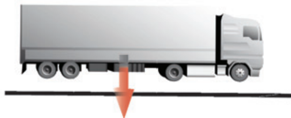
Σχήμα 2.25. Δύναμη βάρους σε επίπεδη επιφάνεια
