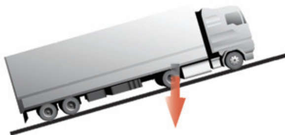
Σχήμα 2.26. Δύναμη βάρους σε ανωφέρεια
