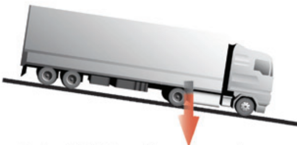
Σχήμα 2.27. Δύναμη βάρους σε κατωφέρεια
