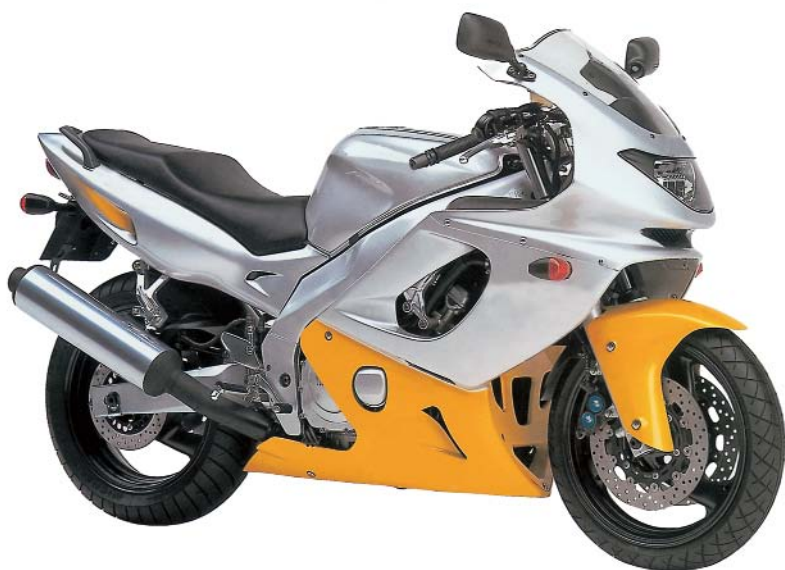
Σχ. 3.5β Ολόσωμη κατασκευή προστασίας.
